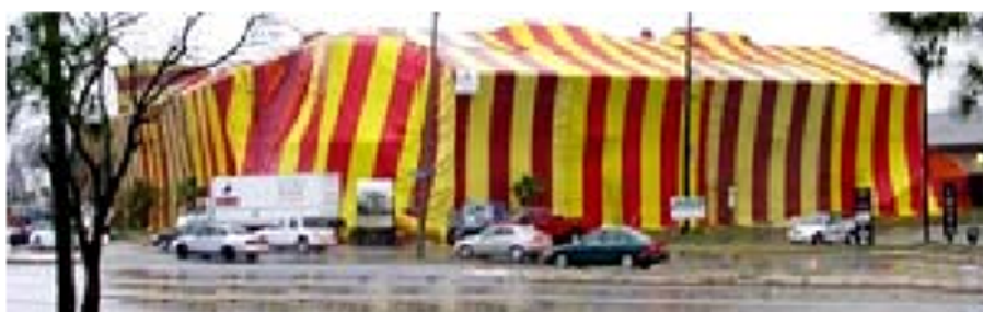
上图是：卡特里娜飓风过后，圆形马戏帐篷覆盖了 7 家餐馆，帐篷内用二氧化氯气体连熏 3 天。二氧化氯气体清除了所有的真菌、霉菌、昆虫和气味。所有的纤维织物和木制品都完好无损。
